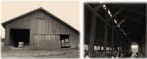
Der Stall wurde bereits von Paul Miller sen. im Jahr 2007 erstellt. Die dreischiffige Konstruktion ist aus sägerauem Vollholz vom Stallbesitzer mit hoher Eigenleistung ausgeführt worden.
